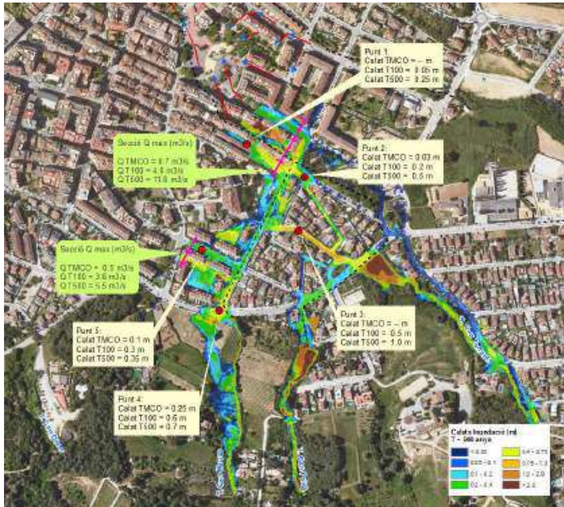
Figura 16. Punts i seccions exemple de calats i cabals màxims assolits en superfície per desbordament als torrents de Can Torrents, Can Paisà i Can Meuxa pels diferents períodes de retorn. Base calats de T500 anys. Ortofotografies ICGC 1:2.500.
