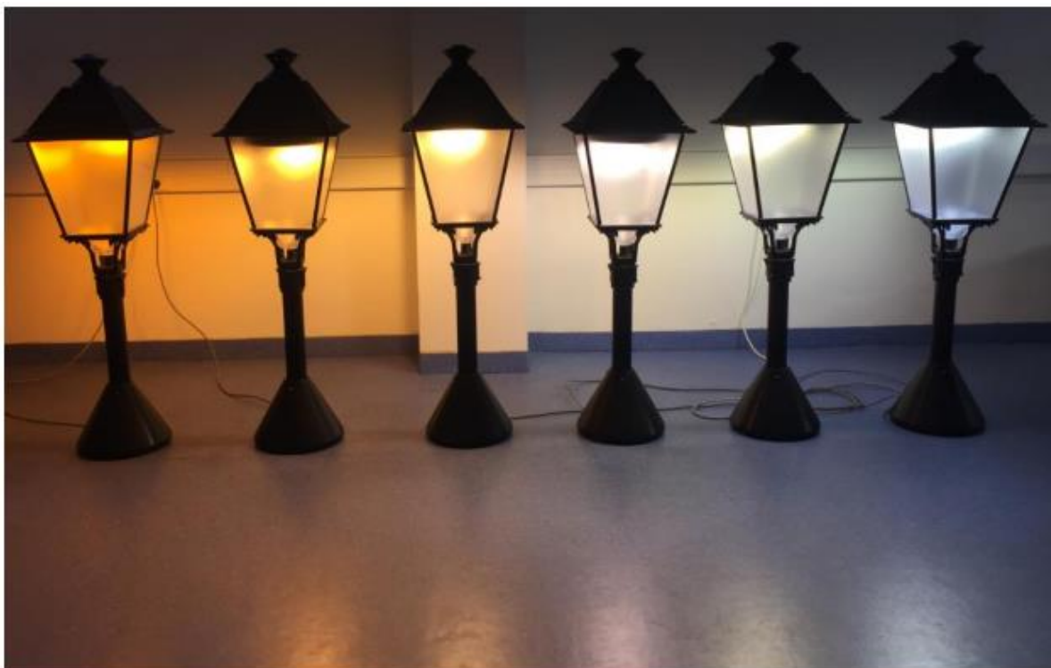
De izquierda a derecha, LED PC-AMBAR, VSAP, LED 2200K, HM (2800K), LED 3000K y LED 4000K.
