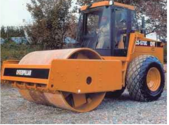
Foto 04: La maquinària disposarà de cabina amb pòrtic antibolcada, d'extintor i dispositiu
