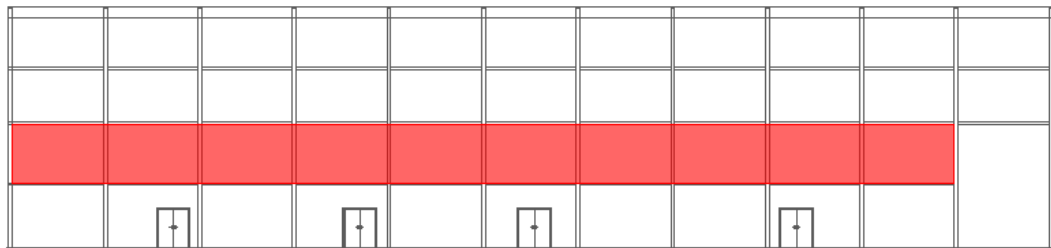
Figura 10.7: Ubicació del revestiment fonoabsorbent a la paret nord-oest (secció)
