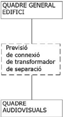
Figura 1.1: Topologia de xarxa d'alimentació elèctrica per a audiovisuals
